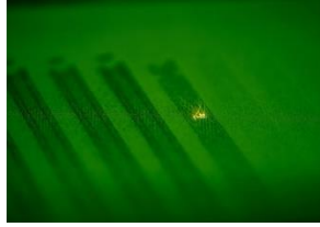
Im Laser Powder Bed Fusion Verfahren verfestigt ein Laserstrahl Metallpulver schichtweise zu Bauteilen.
